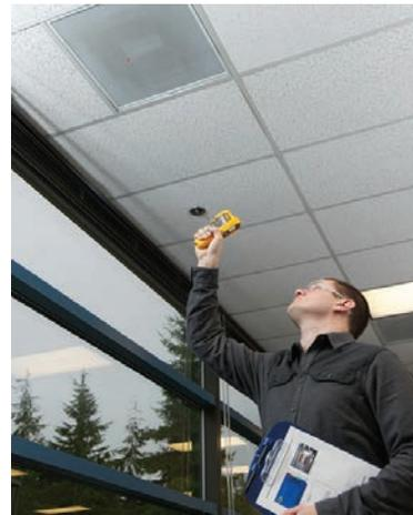
Contrôler la température de refoulement des conduites de distribution d'air.
