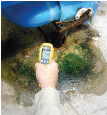
Mesurer la température du condensat à mesure qu'il avance dans la canalisation.
