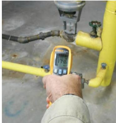
Visualiser la température de la ligne de condensation depuis un purgeur de vapeur, pour s'assurer qu'il fonctionne correctement.
