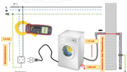
L'ensemble du courant de fuite de l'appareil est calculé à l'aide de la méthode du courant différentiel mesurée via le câble secteur de l'appareil. mesure du courant résiduel en tant que mesure complémentaire au test d'isolement.
