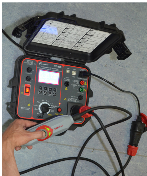
Application pour le test PRCD-S+ et PRCD-K
