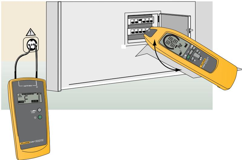
Bild 3 - Anwendungsbeispiel, zuordnen von Stromkreisen zu Sicherungen ohne Abschalten der Anlage
