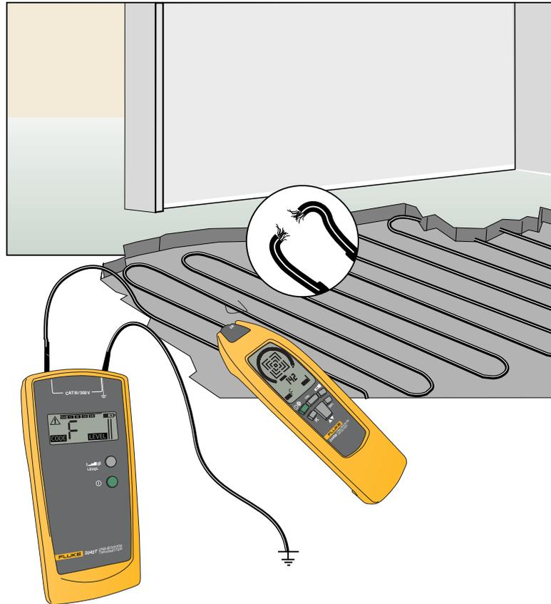
Fehlersuche in einer elektrischen Fußbodenheizung
